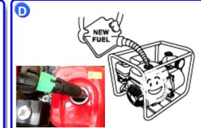
Coloque Gasolina nueva al tanque sin exceder el cuello del tanque a fin de que esta no se derrame
