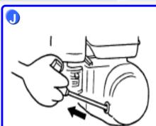
Tire un poco de la empuñadura del arrancador hasta notar resistencia y luego tire con fuerza
