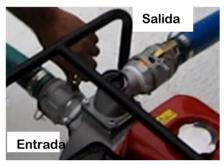
Conecte las mangueras de entrada y de salida de la motobomba
